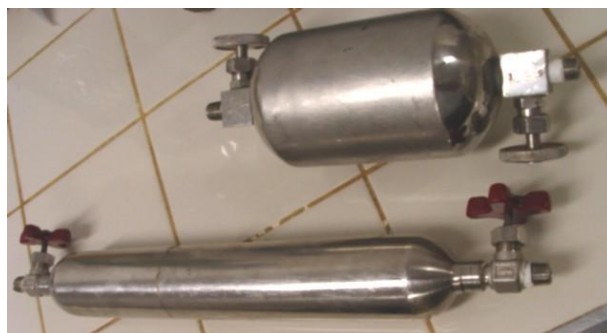
Figura 13: Exemplo de cilindros de amostragem de SF 6 (capacidade 500 ml).
