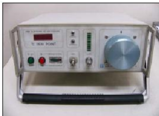
Figura 15 - Instrumento para medição de ponto de orvalho – DP-19.
